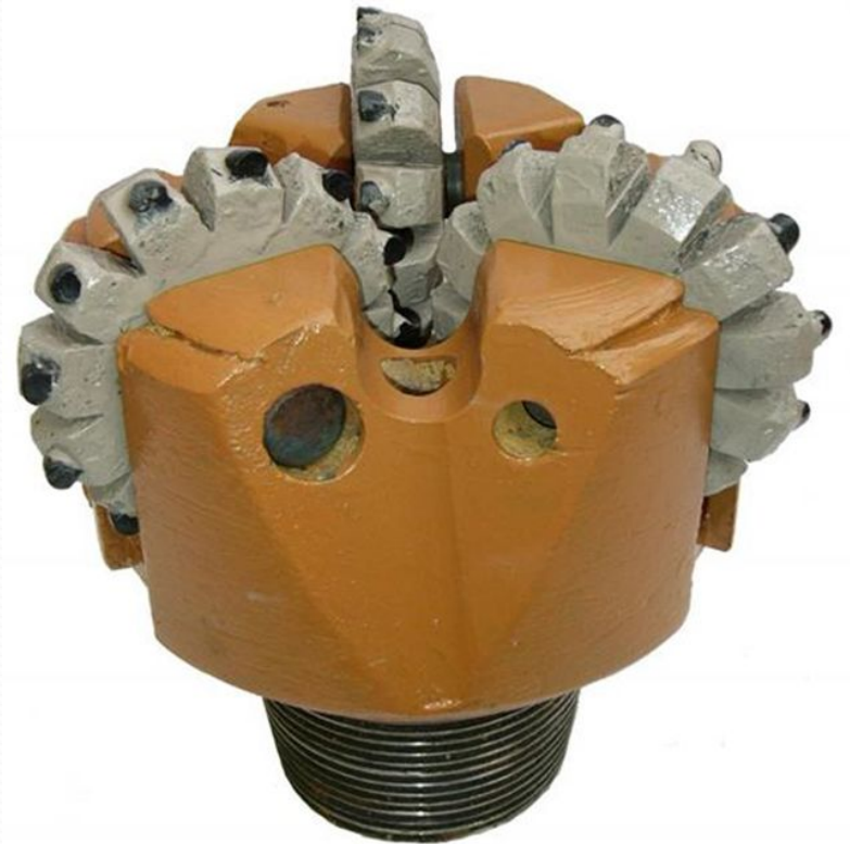
Буровое долото с тремя зубчато-дисковыми шарошками, перекрывающими забой скважины
