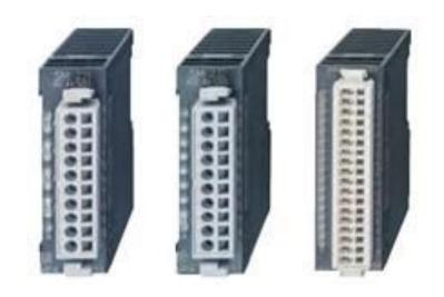
Модуль аналогового ввода SM 231, 8 конфигурируемых каналов, 16 разрядов, входные сигналы: 0...60 мВ, термопары J, K и T, термометр сопротивления Pt100
