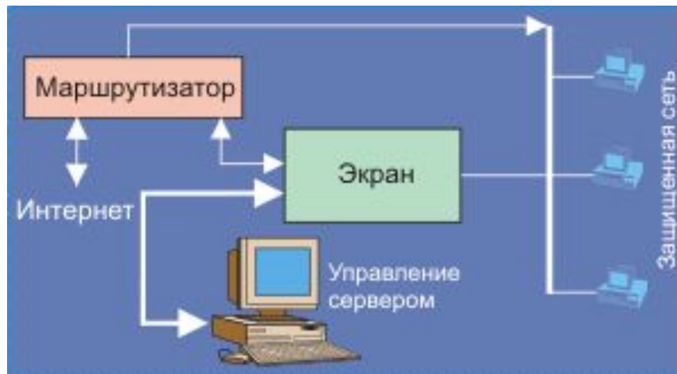
Рис. 5. Схема Firewall, где функцию экрана выполняет маршрутизатор
