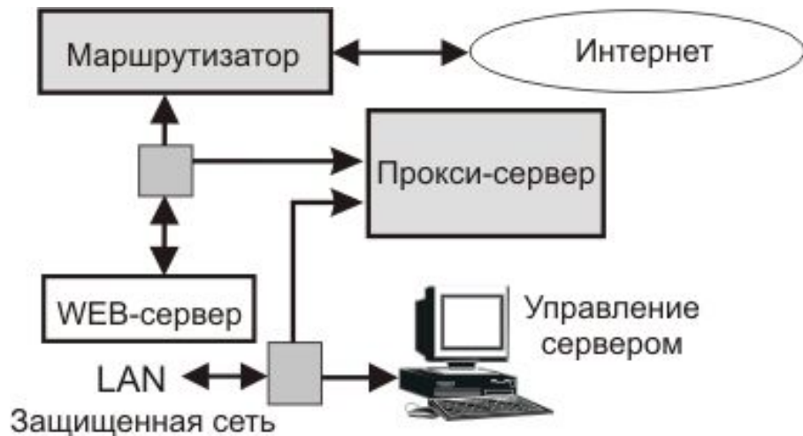
Рис. 6. Размещение WEB-сервера в демилитаризованной зоне
