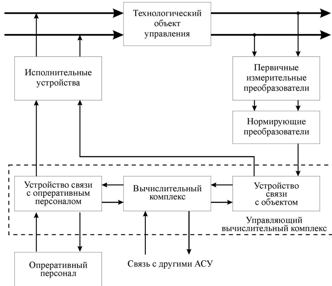
Структурная схема АСУ ТП (функционально-децентрализованная)
