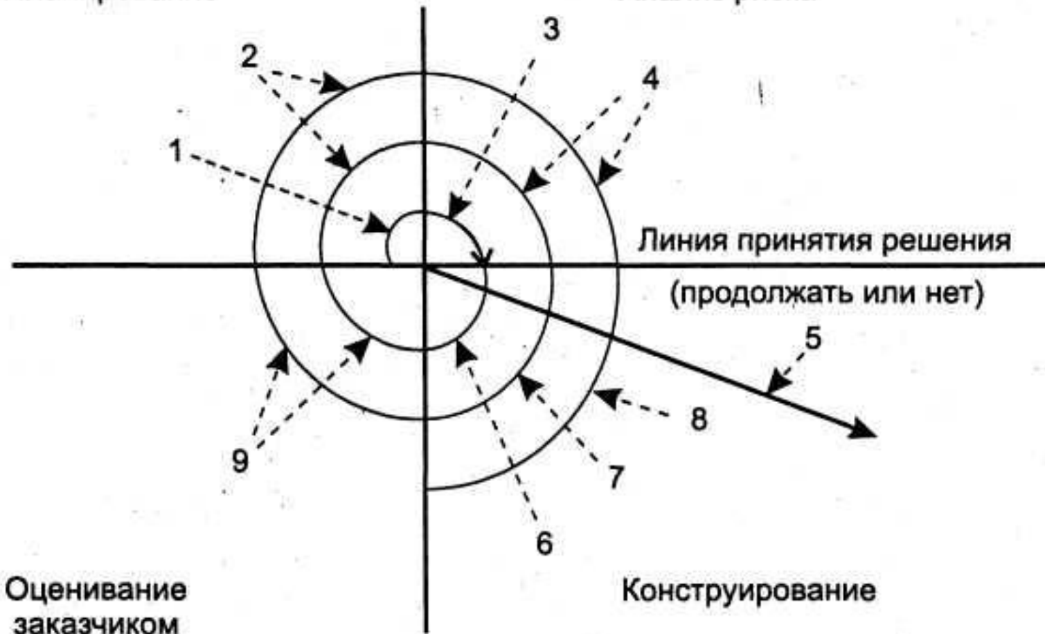
Рис. Спиральная модель: 1 — начальный сбор требований и планирование проекта; 2 — та же работа, но на основе рекомендаций заказчика; 3 — анализ риска на основе начальных требований; 4 — анализ риска на основе реакции заказчика; 5 — переход к комплексной системе; 6 — начальный макет системы; 7 — следующий уровень макета; 8 — сконструированная система; 9 — оценивание заказчиком
