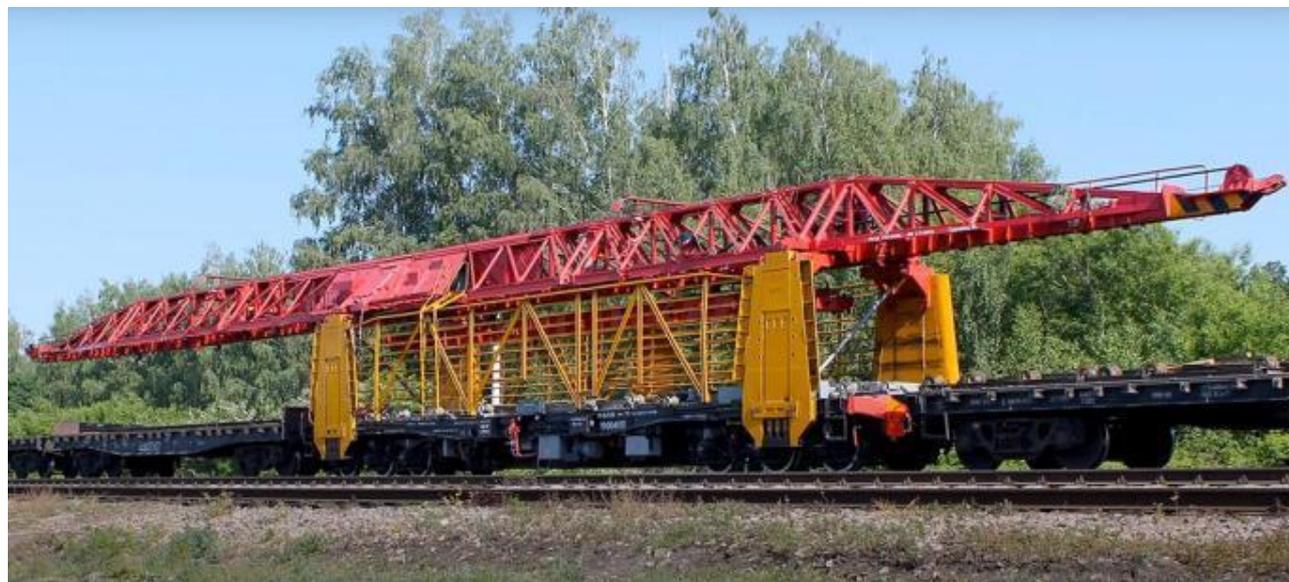
Платформы с УСО предназначены для доставки к месту производства путевых работ рельсошпальной решетки и обратно.
