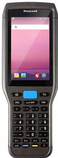
• **Терминал сбора данных**– это портативный компьютер со встроенным сканером штриховых кодов.
