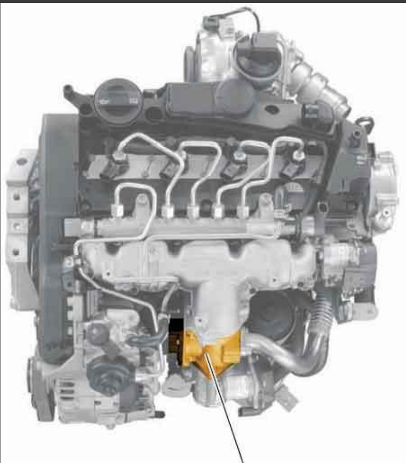
Клапан рециркуляции ОГ N18 с потенциометром системы рециркуляции ОГ G212
