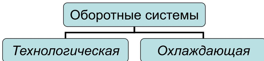
***Технологическая система*** оборотного водоснабжения представляет собой систему, в которой вода используется в качестве растворителя, экстрагента продуктов, транспортирующей среды, вступает в непосредственный контакт с продуктом и загрязняется им.
