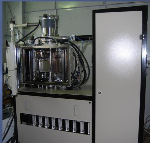
Покрытие толщиной до 50 мкм, состоящих из слоев толщиной 5-10 нм.
