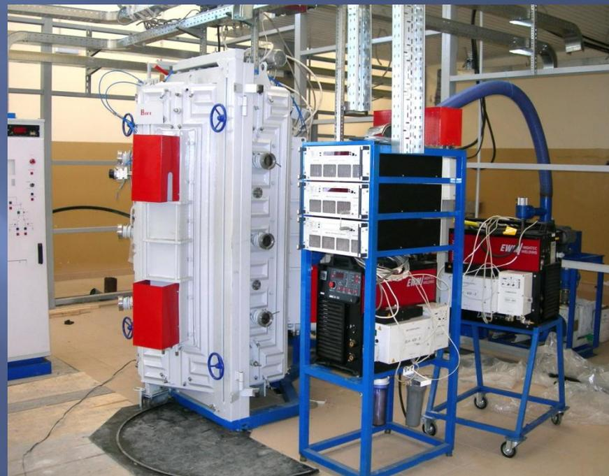
Модификация установки с электродуговыми распылителями предназначена для нанесения твердых, износостойких, трибологических и защитных покрытий на основе как обычных многослойных, так и нанокompозитных пленок на деталях машин и инструменте. Зона обработки до D-700, L-1200 мм.
