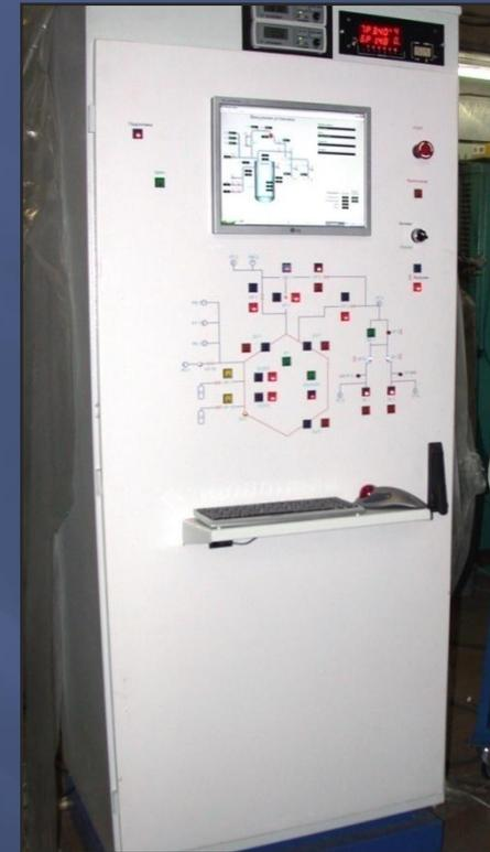
Система управления позволяет в автоматическом режиме проводить все виды обработки подложки и наносить нано-структурированные покрытия, состоящие из слоев на основе чистых металлов и их соединений в любой комбинации.
