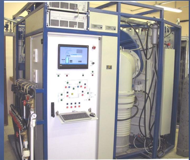
Модификация установки с магнетронными распылителями предназначена для нанесения твердых, износостойких трибологических и защитных покрытий на основе металлов и их соединений на детали машин, металлическую фурнитуру, в том числе из цинкосодержащих сплавов.
