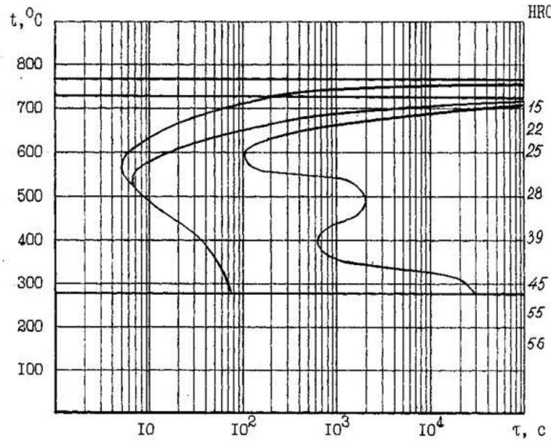
Рисунок 4 - Диаграмма изотермического превращения аустенита (заданной стали)
