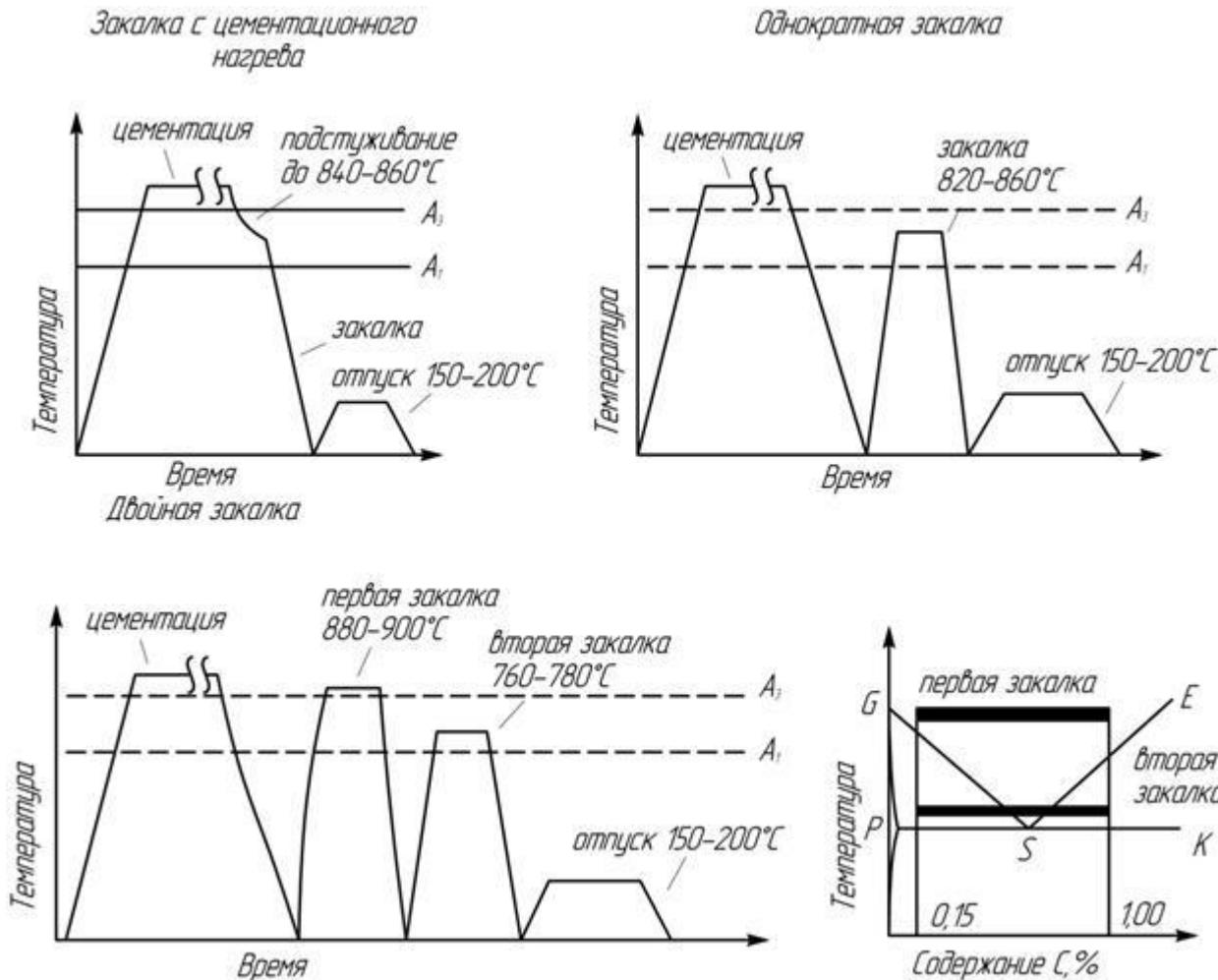
Рисунок 2 - Схемы возможных вариантов термообработки после цементации
