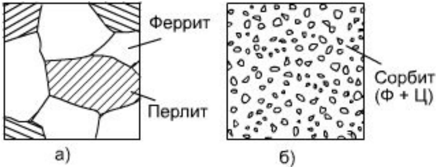
Рисунок 3 - Схема микроструктуры стали:
