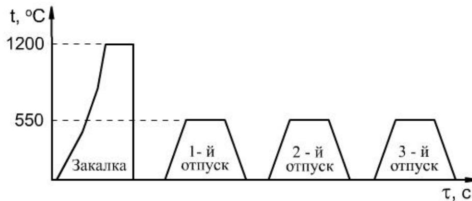
Рисунок 2 - Схема термической обработки быстрорежущей стали
