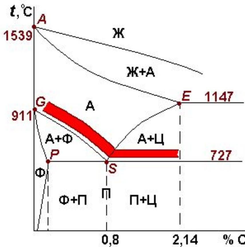
Рисунок 1 - Стальной участок диаграммы состояния железо-цементит, указать заданную марку стали (до и после ХТО если применяется), температуру термической обработки.
