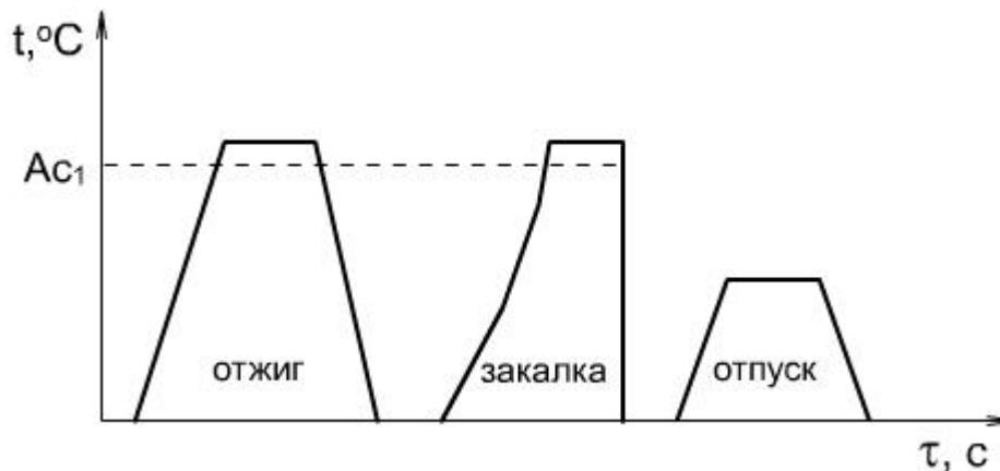
Рисунок 2 - Схема термической обработки (без ХТО)
