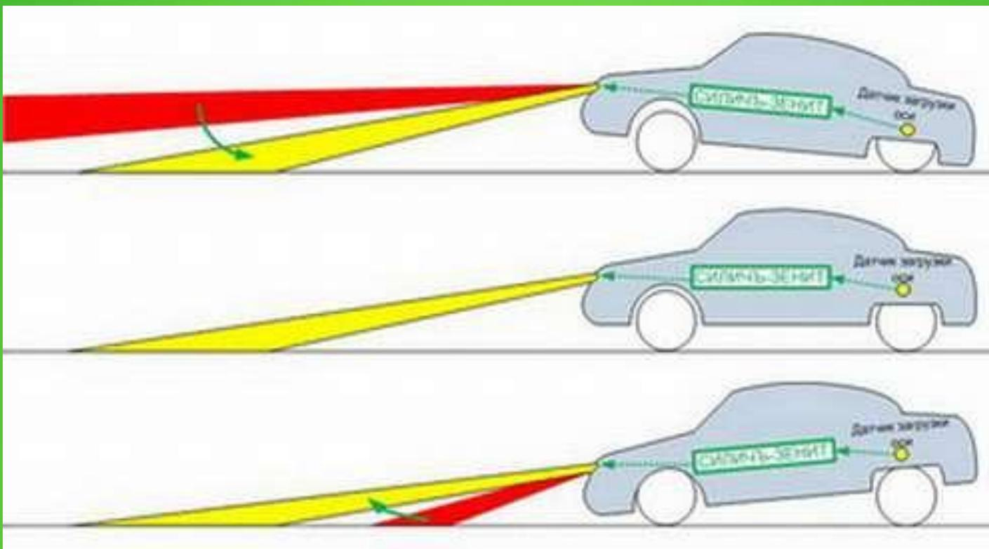
Свет, формируемый оптикой машины, настраивается при незагруженном автомобиле (на рисунке выделен желтым цветом). Однако световой поток меняется в зависимости от загрузки авто, смещаясь вверх или вниз от правильной оптической оси (отображается на рисунке красным цветом). Для исправления такого изменения и служит корректор фар.
