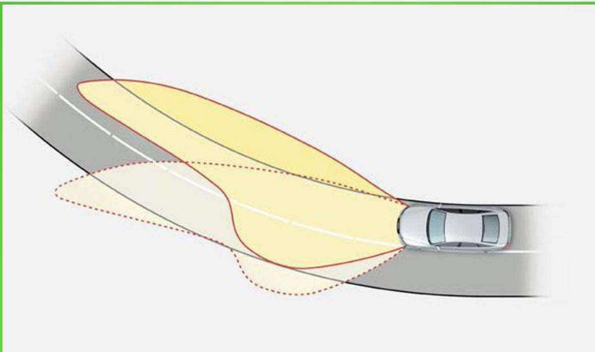
В автомобиле, где установлены адаптивные фары, присутствует оснащение электронным сенсором, определяющим скорость самого движения и угол при повороте руля. Датчики получают активацию от небольших блоков питания, встроенных в корпусе лампы, и сами задают направление нужного освещения. Адаптивный фонарь рассеивает свет (угол 15 градусов), это значит, что диапазон общего освещения равен 30 градусам.
