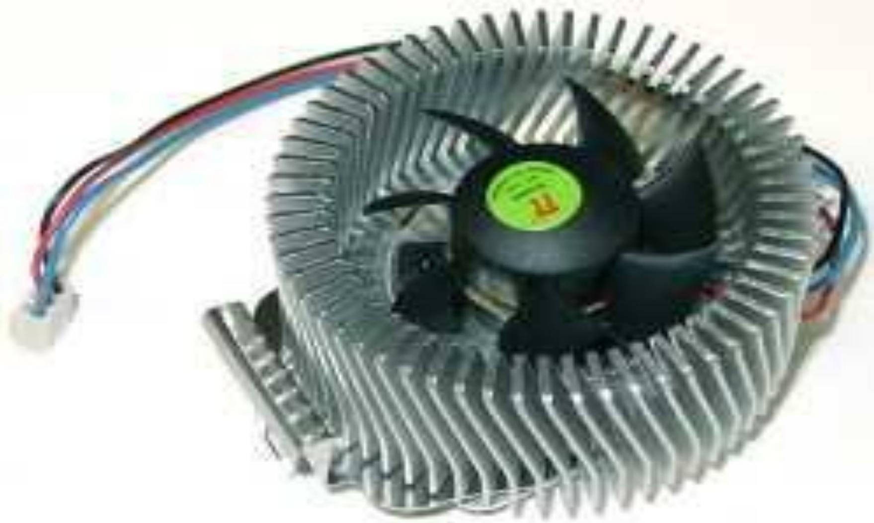
***Кулер*** - устройство с большим количеством ребер, которое оборудуют вентилятором, предназначенное для охлаждения корпуса центрального процессора.
