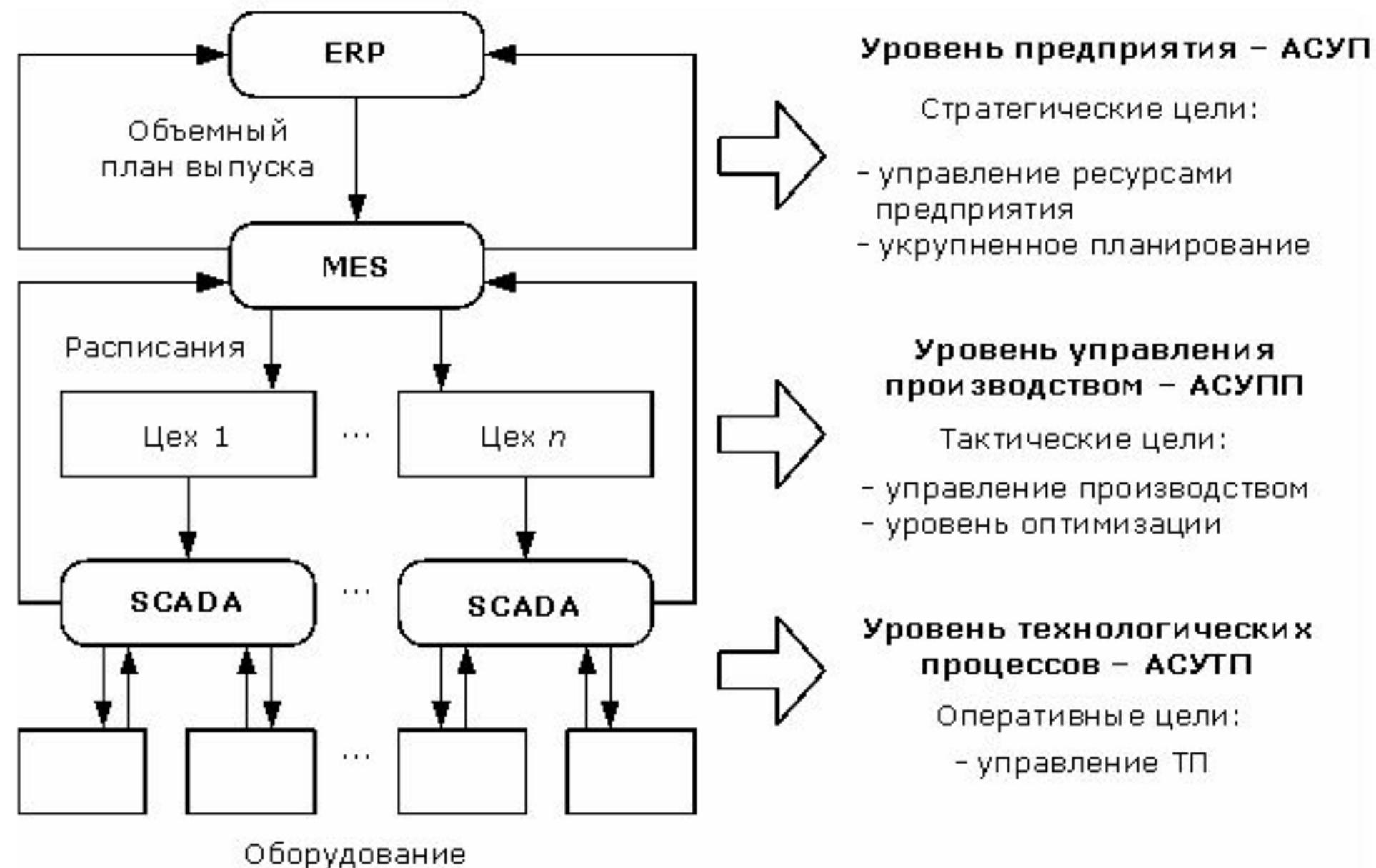
Рис 1. Структура децентрализованной АСУП
