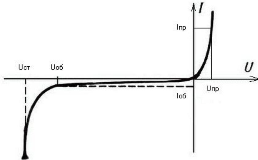
Рис 2. Вольт-амперная характеристика полупроводникового диода с p-n — переходом
