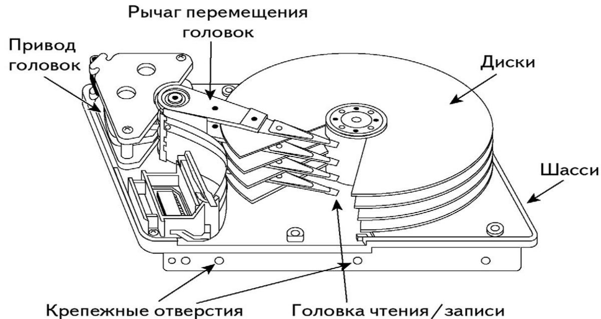
Диски (пластины), как правило, изготовлены из металлического сплава. Хотя были попытки делать их из пластика и даже стекла (IBM), но такие пластины оказались хрупкими и недолговечными. Обе плоскости пластин, подобно магнитофонной ленте, покрыты тончайшей пылью ферромагнетика\* — окислов железа, марганца и других металлов. Большинство бюджетных устройств содержит одну или две пластины, но существуют модели с бóльшим числом пластин.
