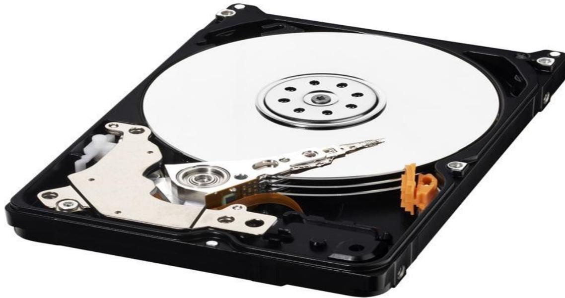
В отличие от гибкого диска (дискеты), информация в НЖМД записывается на жёсткие (алюминиевые или стеклянные) пластины, покрытые слоем ферромагнитного\* материала, чаще всего диоксида хрома — магнитные диски.
