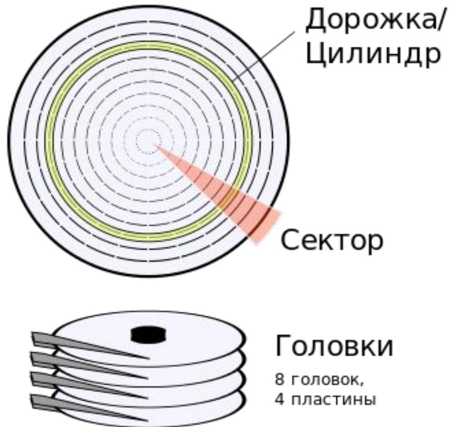
*Цилиндр* — совокупность дорожек, равноотстоящих от центра, на всех рабочих поверхностях пластин жёсткого диска. *Номер головки* задаёт используемую рабочую поверхность, а *номер сектора* — конкретный сектор на дорожке.
