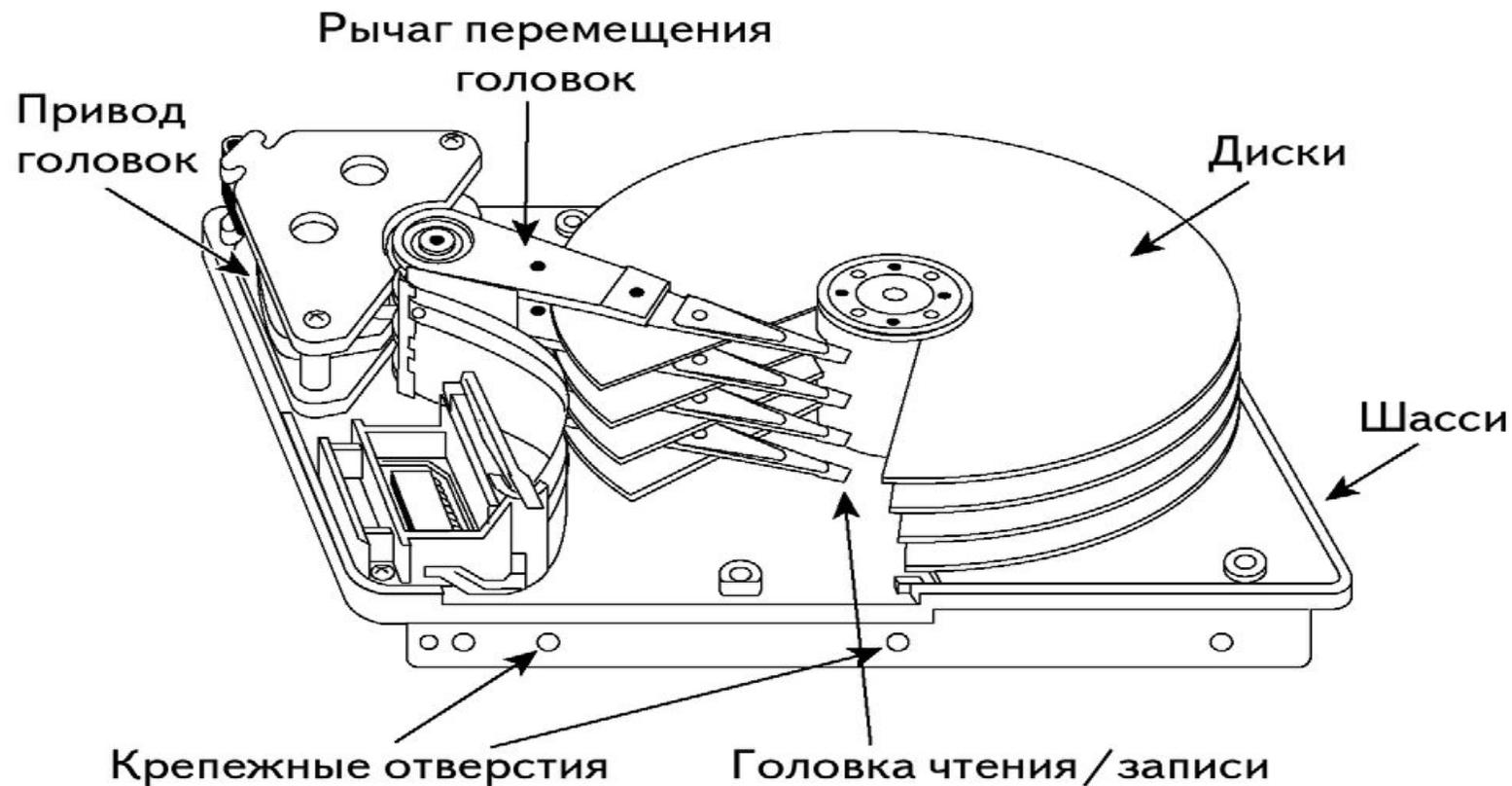
Расстояние между головкой и диском составляет несколько нанометров (в современных дисках около 10 нм), а отсутствие механического контакта обеспечивает долгий срок службы устройства.
