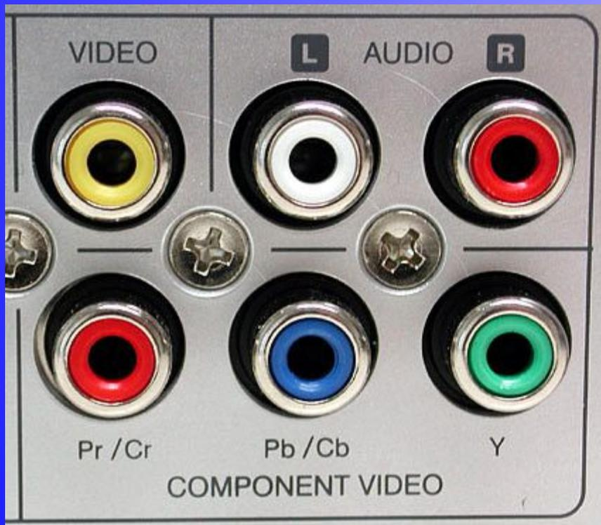
**"Тюльпан" (Cinch/RCA): композитный видео, аудио, HDTV**
