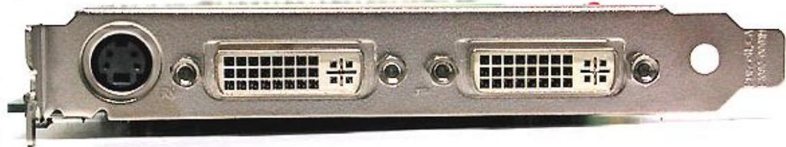
Графическая карта с двумя портами DVI может работать одновременно с двумя (цифровыми) мониторами.
