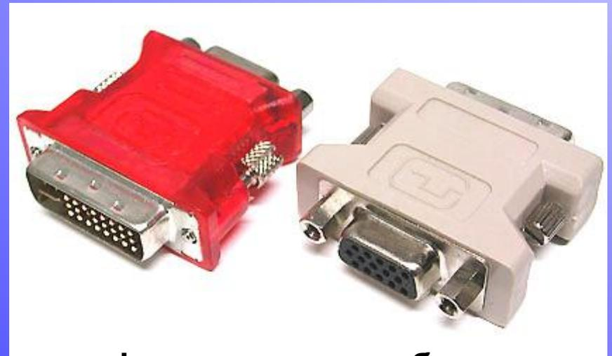
**Новые графические карты обычно оснащаются двумя выходами DVI. Но с помощью переходника DVI-VGA можно легко изменить интерфейс**
