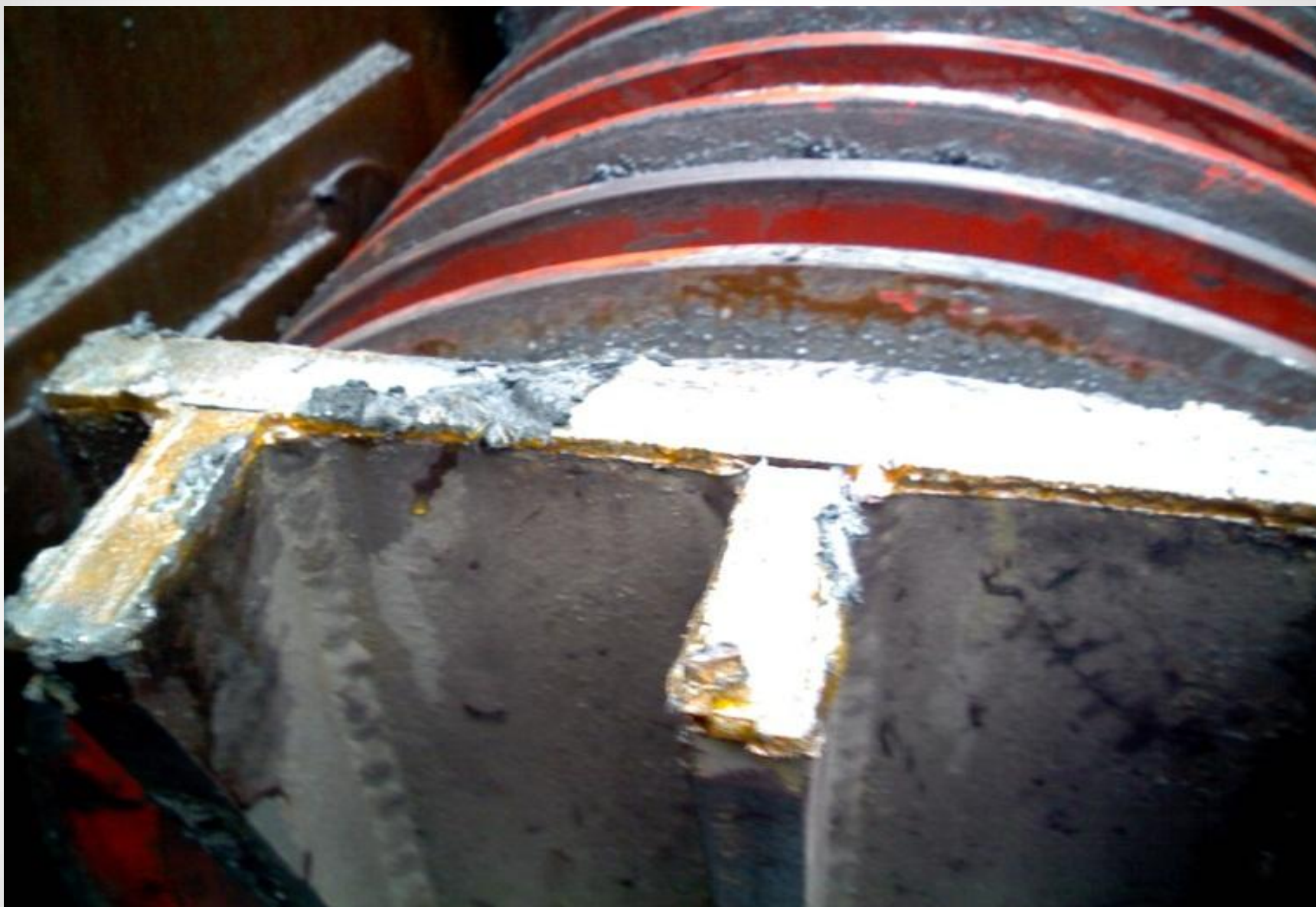
Обрыв корпуса верхних полиспастов
