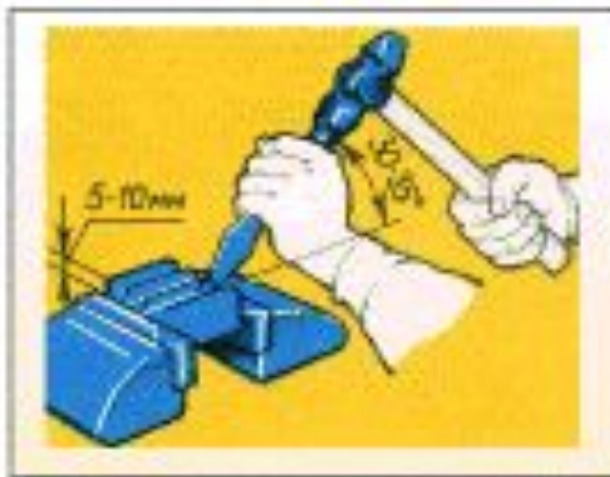
Срубание слоя металла на широкой плоской поверхности
