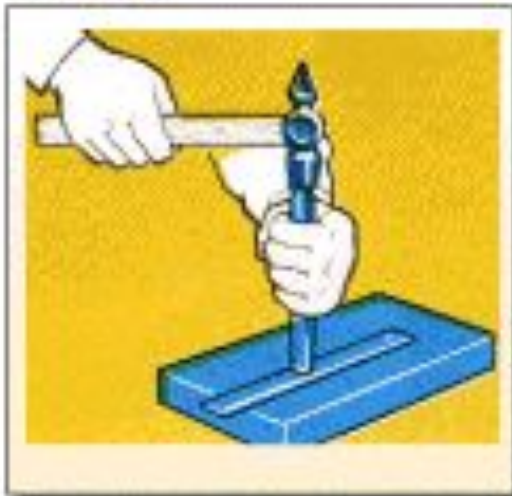
Рубка по разметочным рискам
