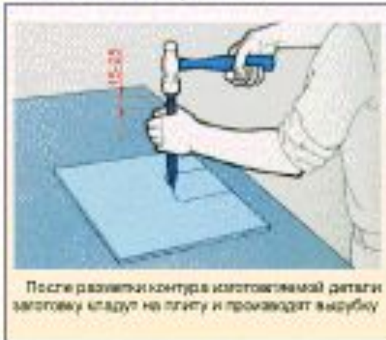
Срубание слоя металла на широкой плоской поверхности
