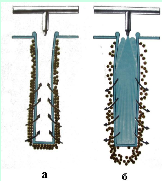
Схема работы рукавного фильтра: а – очистка от пыли, б – регенерация фильтра сжатым воздухом.
