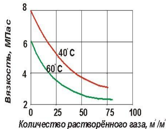
Рис.20. Изменение вязкости нефти при насыщении её газом
