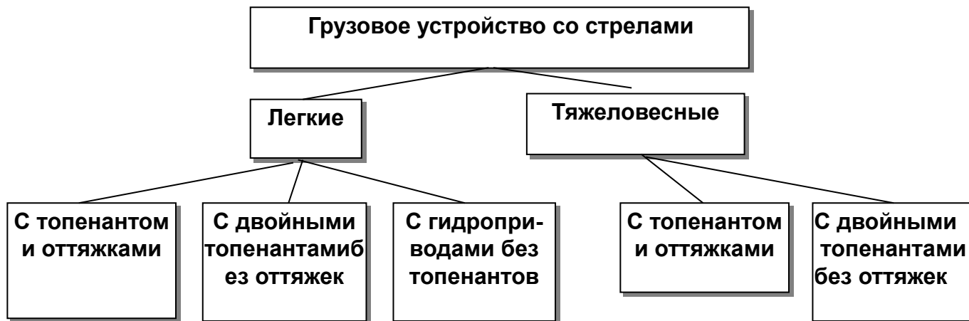
Классификация грузовых устройств со стрелами
