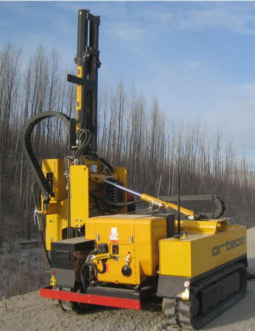
Сваебойная установка предназначена для забивки металлических свай и стоек дорожного ограждения, а также выполнения вспомогательных работ при строительстве и эксплуатации автомобильных дорог и дорожных сооружений, для работы с гидравлическим инструментом.
