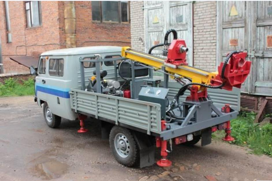
Малогабаритные буровые станки на шасси УАЗ УБМ-230/250 для инженерных изысканий, гидрогеологии, а также для ремонта старых скважин и колодцев и бурения «на воду».
