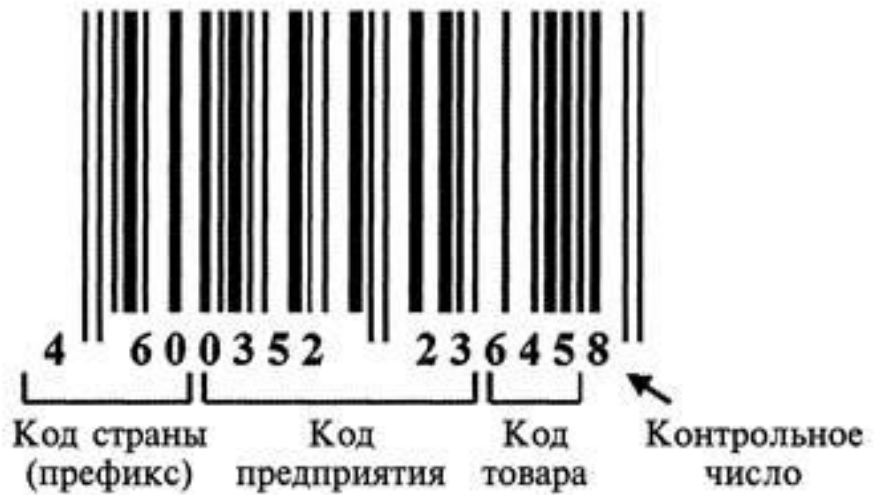
Рис. 7.5. Код EAN-13. Внешний вид и структура. Применяется для кодирования в основном товаров народного потребления.
