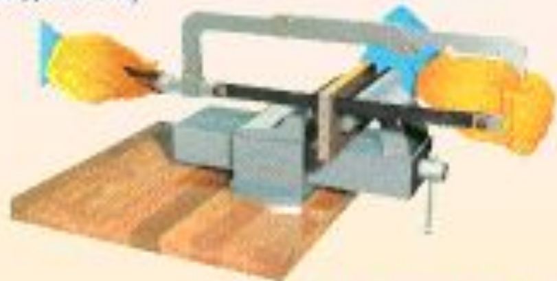
Установка полотна при неглубоком прорезе
