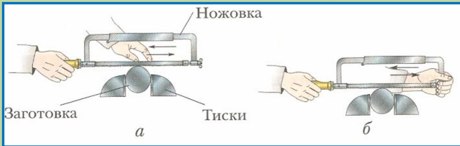
Приемы резания заготовок круглого сечения:
