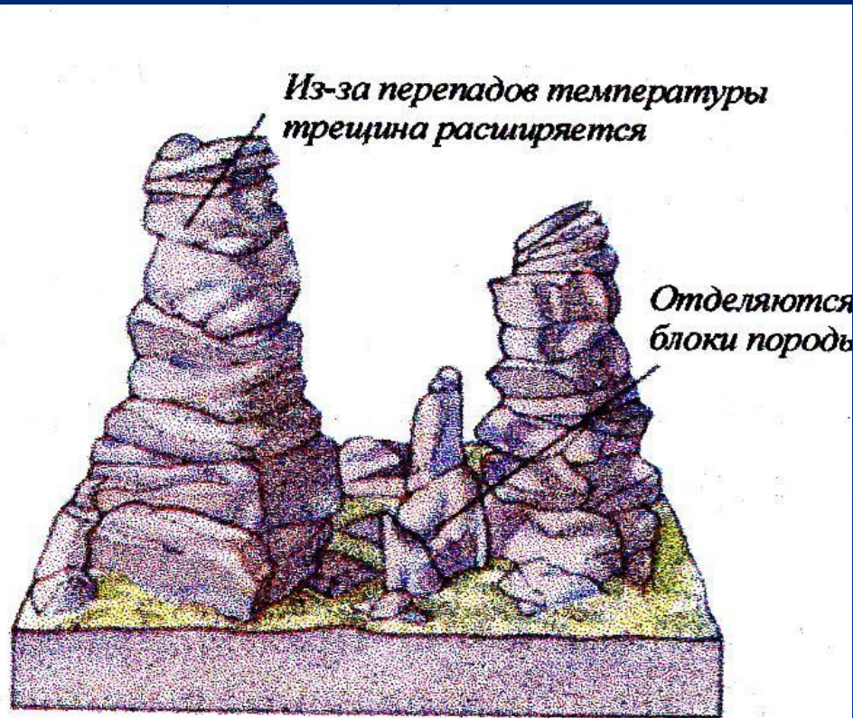
Выветривание по трещиноватости
