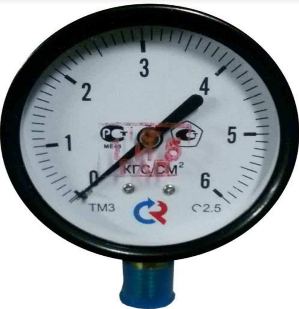
Манометр класса точности 2,5
