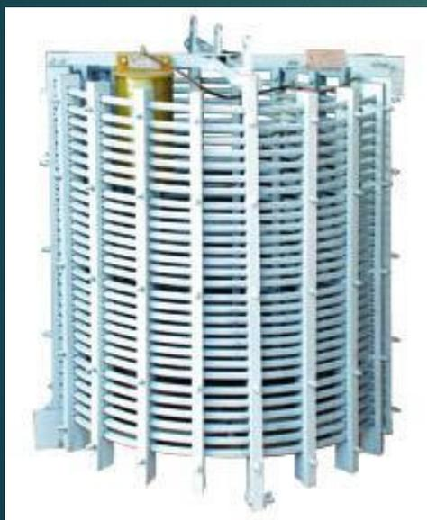
Для отделения ВЧ сигнала от высоковольтного оборудования подстанции в фазный провод ВЛ высокого напряжения монтируется ВЧ заградитель, который ограничивает величину потерь ВЧ сигналов через параллельные контуры.
