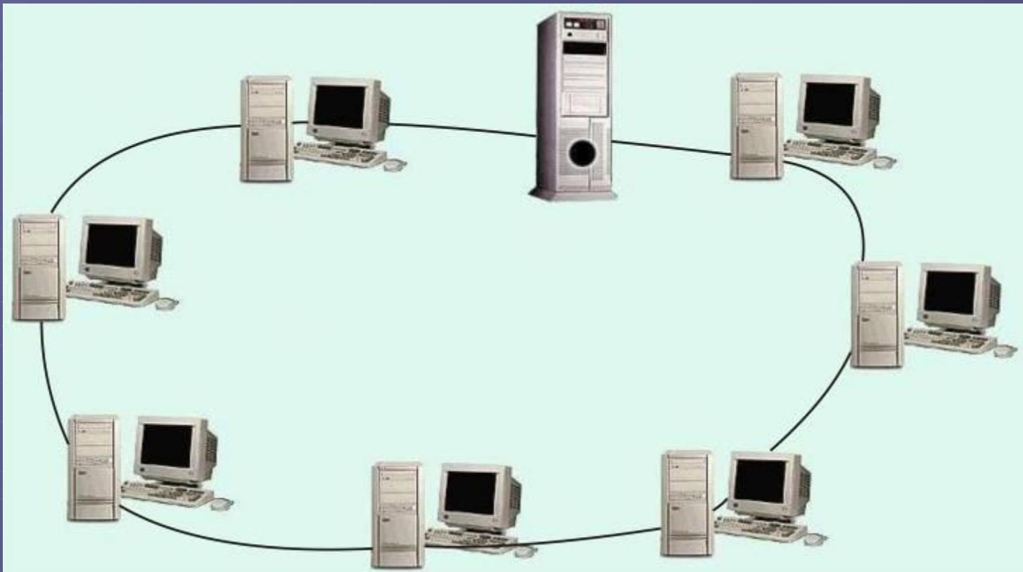
Файл-сервер и рабочие станции соединены кабелем в кольцо. Сообщения рабочей станции могут проходить через несколько других рабочих станций до того, как они достигнут файла-сервера.
