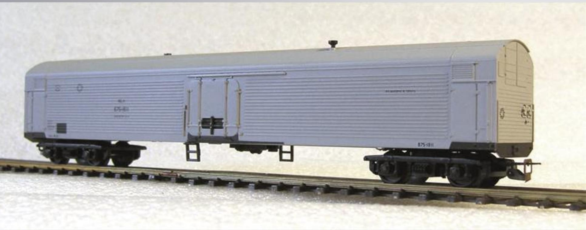
**Рефрижераторный контейнер** – это специализированный стандартизированный контейнер со встроенной рефрижераторной установкой, обеспечивающий перевозку скоропортящихся товаров на железнодорожном, морском и автомобильном транспорте без перегруза перевозимой скоропортящейся продукции при переходе с одного транспорта на другой.
