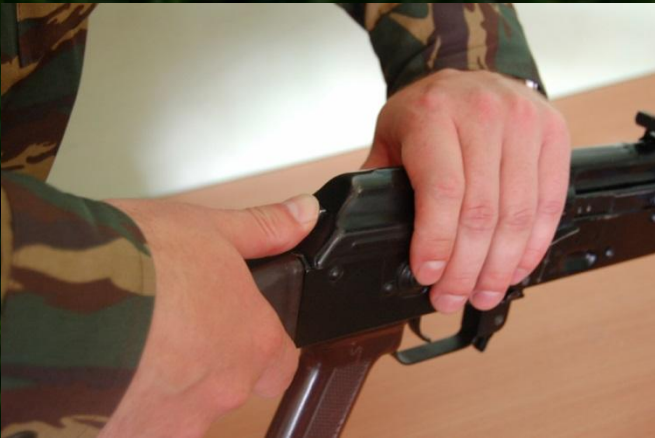
Рис. 4. Отделение крышки ствольной коробки
