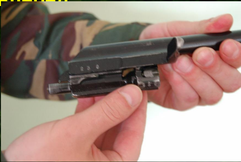
Рис. 7. Отделение затвора от затворной рамы
