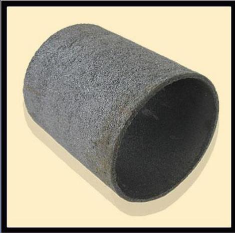
**Серый чугун** – это такой чугун, в котором большая часть углерода находится в свободном состоянии, т.е. в виде графита. Серый чугун мягок, хорошо обрабатывается режущим инструментом, поддается сварке и термической обработке. Чем больше в чугуне углерода, тем ниже температура его плавления и выше жидкотекучесть.
