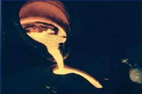
**Ковкий чугун** получают из белого чугуна термической обработкой - длительной выдержкой при температуре **800 – 850 градусов** Цельсия. При этом углерод в чугуне выделяется в виде хлопьев свободного углерода, располагающегося между кристаллами чистого железа.
