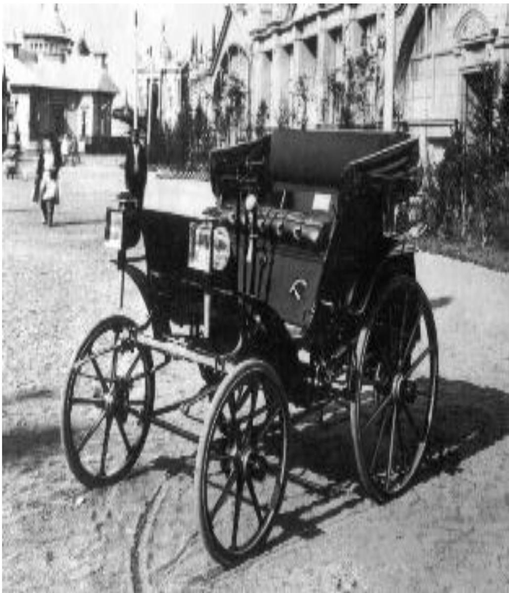
Вес готовой модели составил 300 кг. Бензиновый двигатель заключал в себе две лошадиные силы, позволял проехать без дозаправок 10 часов и мог разгоняться до скорости в 21 км в час.
