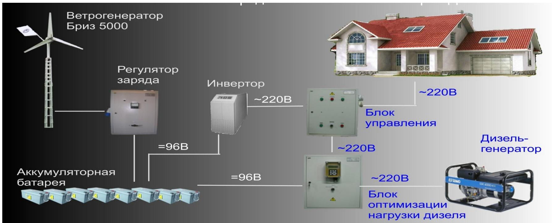
Комплекс предназначен для гарантированного электроснабжения объектов, расположенных в зонах со средними и слабыми ветрами. Обеспечивает потребителей качественной электроэнергией (220В, 50Гц).
