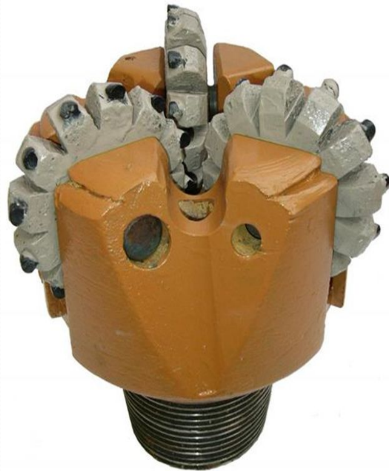
Буровое долото с тремя зубчато-дисковыми шарошками, перекрывающими забой скважины
