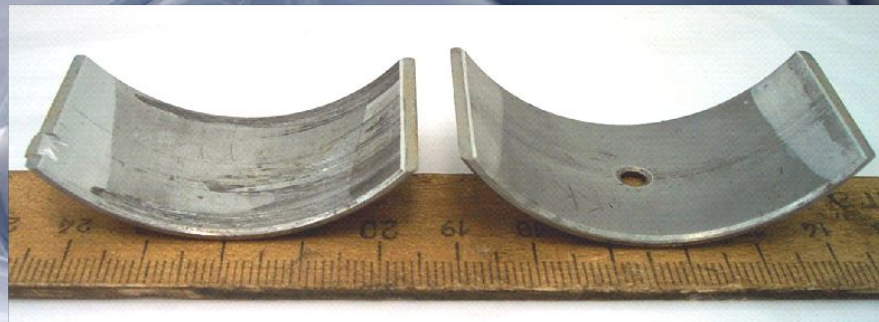
Рис. 1. Образцы, подготовленные к исследованию структуры приповерхностного слоя.
