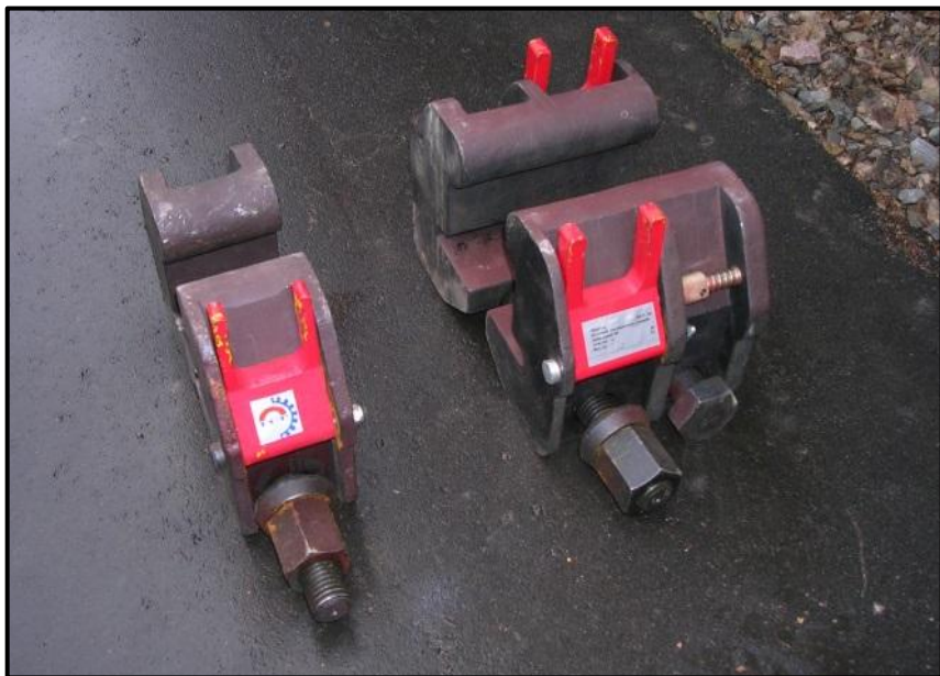
Одинарная (2 шт. шириной 70 мм) и двойная (1 шт. шириной 140 мм) струбцины ПСС-36
