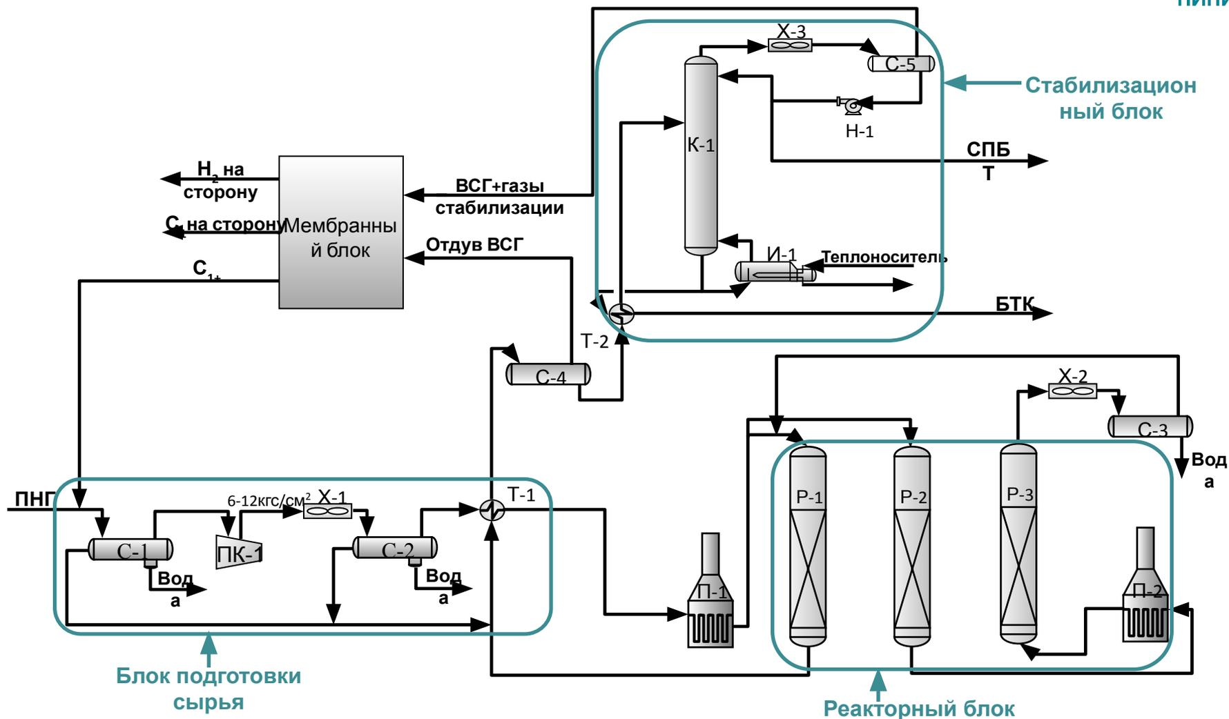
С-1 – С-5 – сепараторы; ПК-1 – компрессор; X-1 – X-3 – воздушные холодильники; Т-1, Т-2 – теплообменники; П-1, П-2 – печи; К-1 – стабилизационная колонна; Р-1 – Р-3 – реакторы; И-1 – испаритель; Н-1 – насос.
