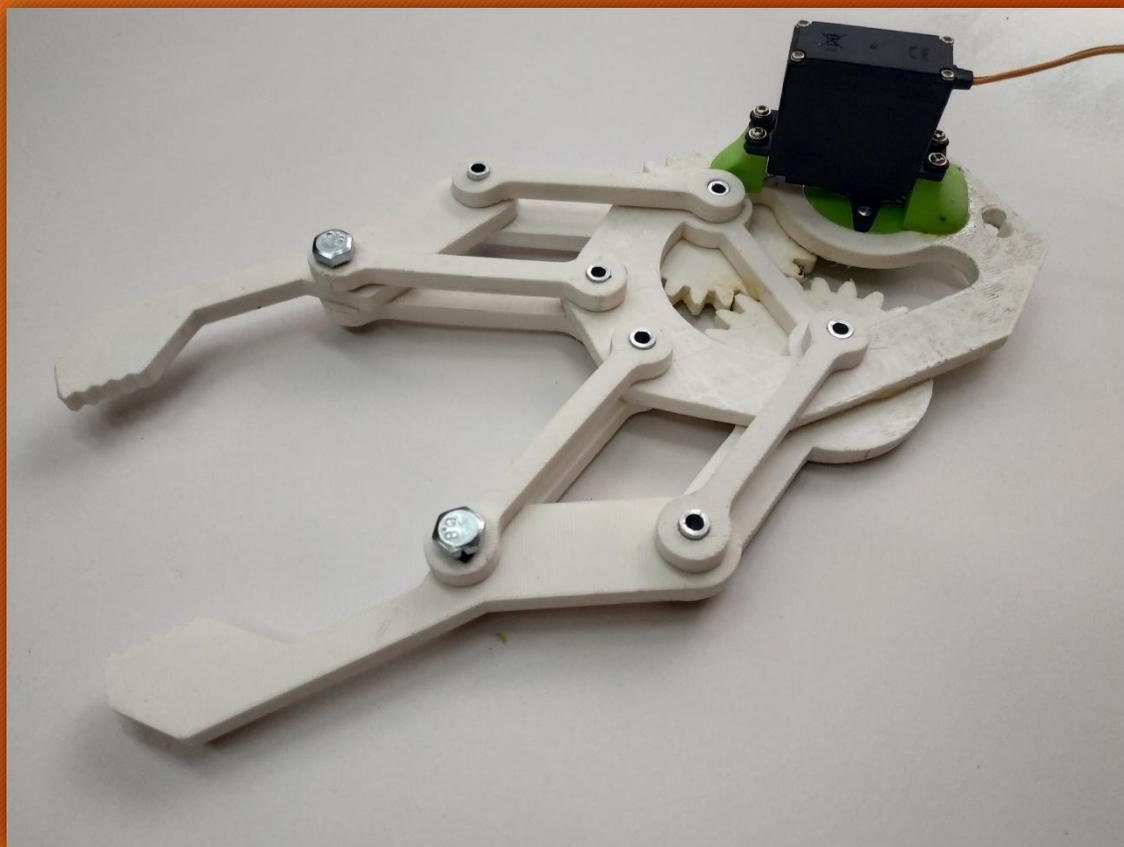
В качестве прототипа использовался двухпальцевый захват с четырёхрычажной тягой.
