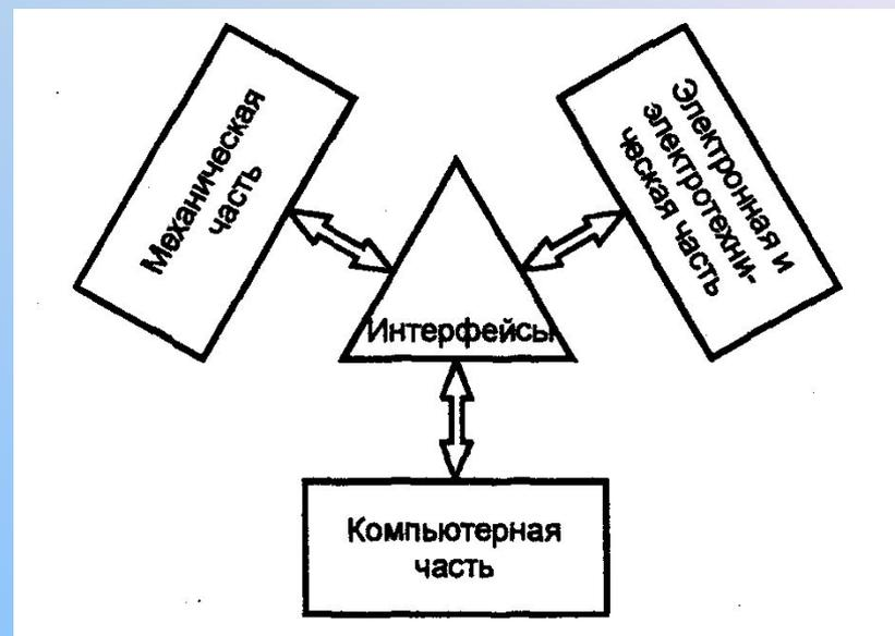
Рис. 1.1. Компоненты мехатронных систем
