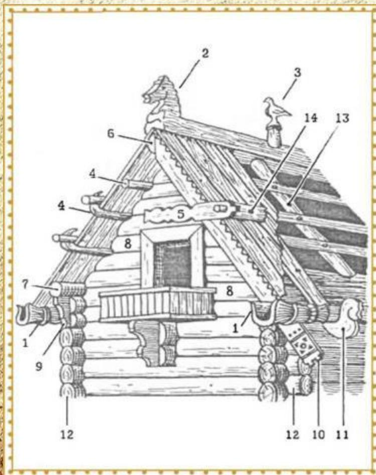
Схема устройства кровли:
