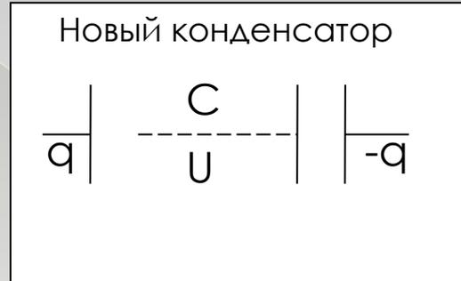
**Общая емкость меньше емкости любого из последовательно соединенных конденсаторов.**
