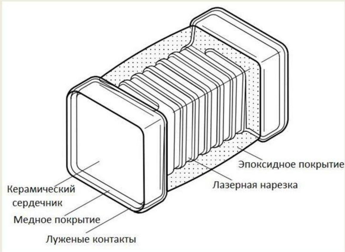
Рис. 18. Конструкция ЧИП-индуктивность
