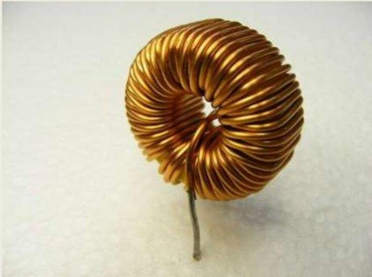
Рис. 17. Торoidalная конструкция индуктивности
