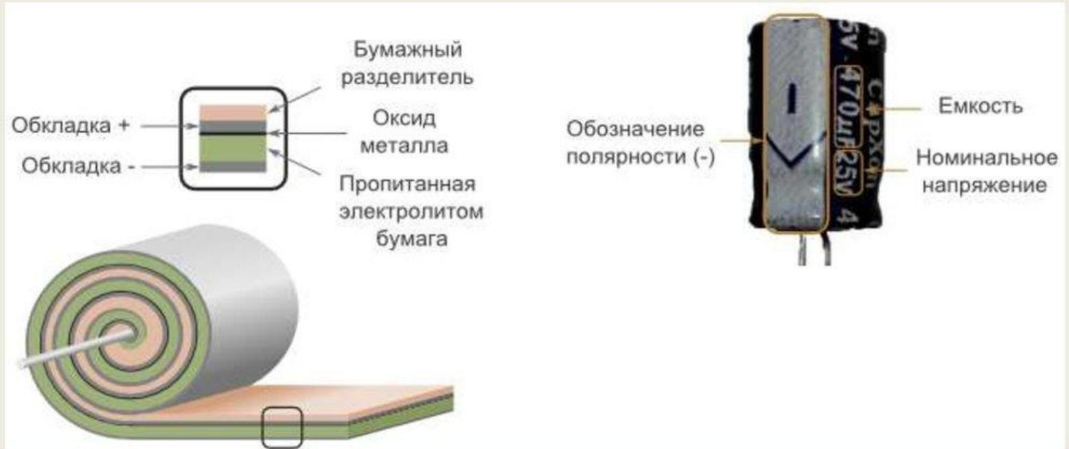
Рис. 12. Рулонная конструкция на примере электролитического конденсатора
