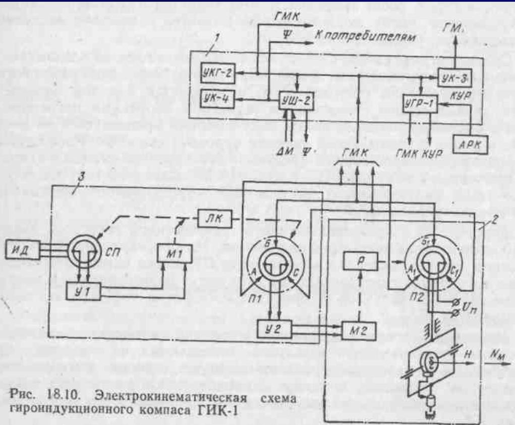
Рис. 18.10. Электрокинематическая схема гироиндукционного компаса ГИК-1
