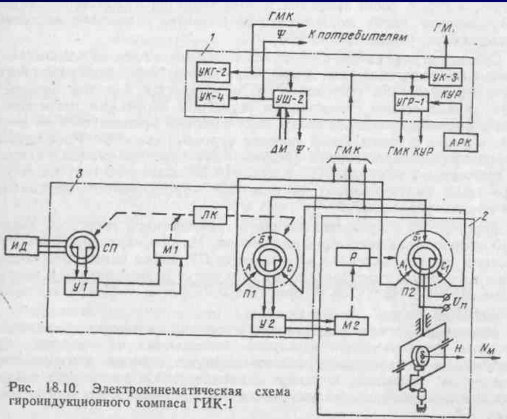
Рис. 18.10. Электрокинематическая схема гироиндукционного компаса ГИК-1
