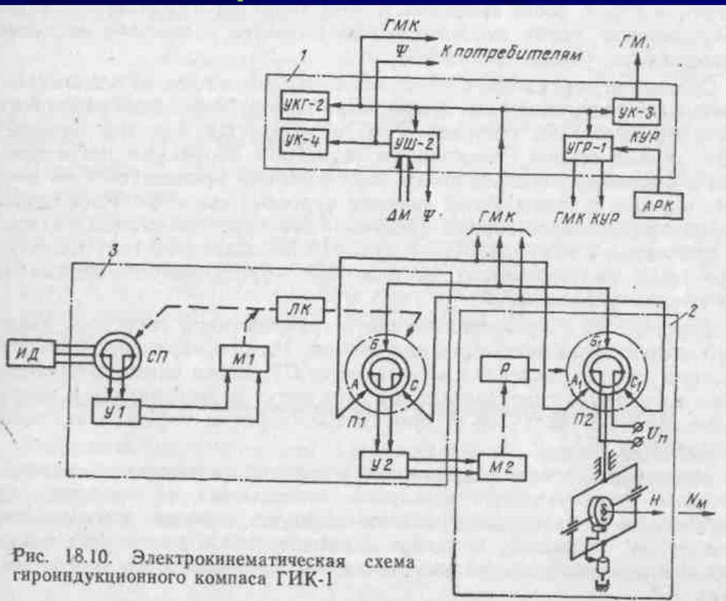
Рис. 18.10. Электрокинематическая схема гироиндукционного компаса ГИК-1
