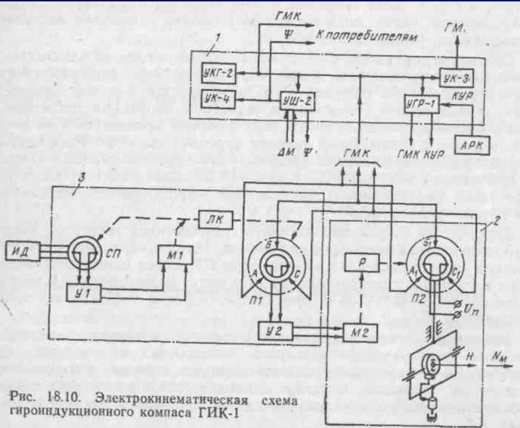
Рис. 18.10. Электрокинематическая схема гироиндукционного компаса ГИК-1
