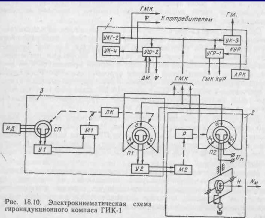
Магнитная система индукционного датчика состоит из трех индукционных чувствительных элементов, помещенных на поплавке, закрепленном в кардановом подвесе корпуса датчика, заполненного жидкостью. Жидкость, поплавок и кардановый подвес обеспечивают положение магнитной системы, близкое к горизонтальному при эволюциях ЛА.
