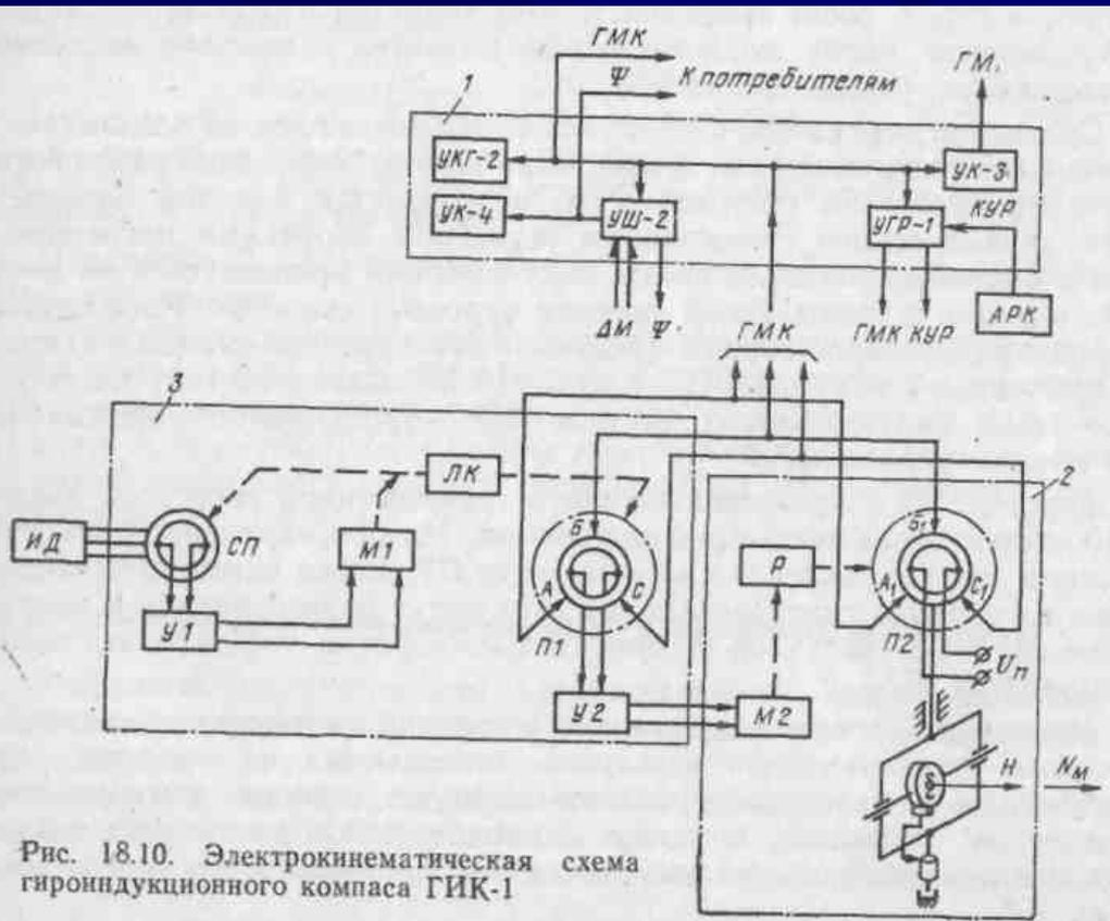
При повороте ЛА щетки потенциометра П2, связанные с корпусом гироагрегата, также развернутся относительно корпуса потенциометра, закрепленного на оси наружной рамы гироскопа.
