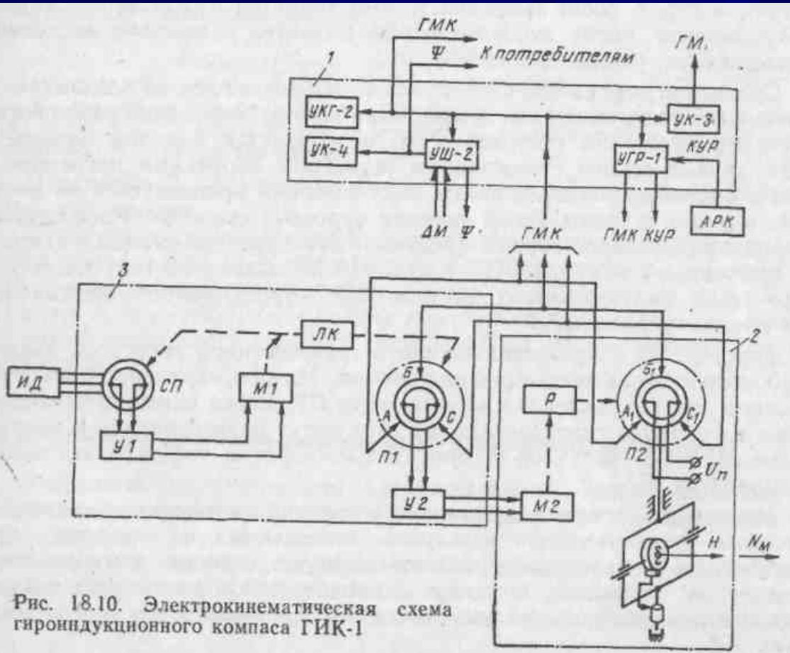
Рис. 18.10. Электрокинематическая схема гиросиндукционного компаса ГИК-1
