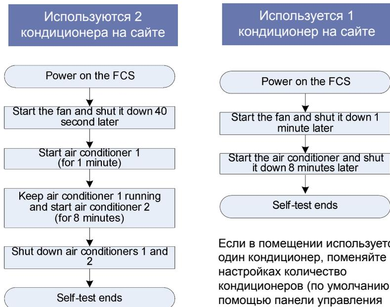
Если в помещении используется один кондиционер, поменяйте в настройках количество кондиционеров (по умолчанию, 2) с помощью панели управления контроллера с LCD экраном
