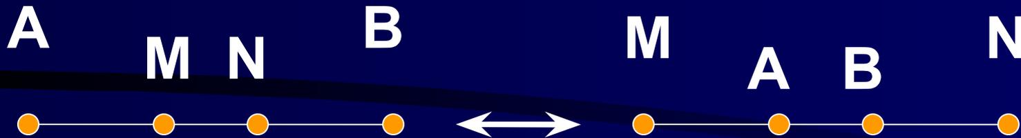
1. Использование полевых инверсных установок приводит к автоматизации процесса сбора данных и дает возможность использовать многоканальные установки. Полезный сигнал не меняется, а пропорционально длине линии MN возрастают помехи.
