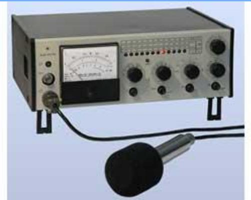
В качестве приборов для измерений вибрации используют **виброметры** и **шумомеры с дополнительным приспособлением**, отечественные приборы ВШВ 003-М2 и приборы датской фирмы «Брюль и Кьер». В соответствии с ГОСТ 12.4.012-83 «Вибрация. Средства измерения и контроля вибрации на рабочих местах».
