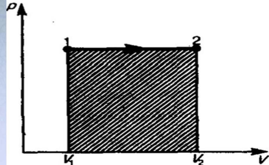
Из этого выражения вытекает физический смысл молярной газовой постоянной  $R$ : если  $T_2 - T_1 = 1 \text{ K}$ , то для 1 моль газа  $R = A$ , т. е.  $R$  численно равна работе изобарного расширения 1 моль идеального газа при нагревании его на 1 К.
