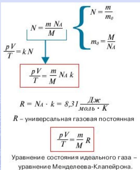
Французский физик и инженер Б. Клапейрон (1799–1864) вывел уравнение состояния идеального газа, объединив законы Бойля – Мариотта и Гей-Люссака. Пусть некоторая масса газа занимает объем  $V_1$ , имеет давление  $p_1$  и находится при температуре  $T_1$ . Эта же масса газа в другом произвольном состоянии характеризуется параметрами  $p_2'$ ,  $V_2'$ ,  $T_2$ . Переход из состояния 1 в состояние 2 осуществляется в виде двух процессов: 1) изотермического (изотерма 1–1'), 2) о (изохора 1'–2).
