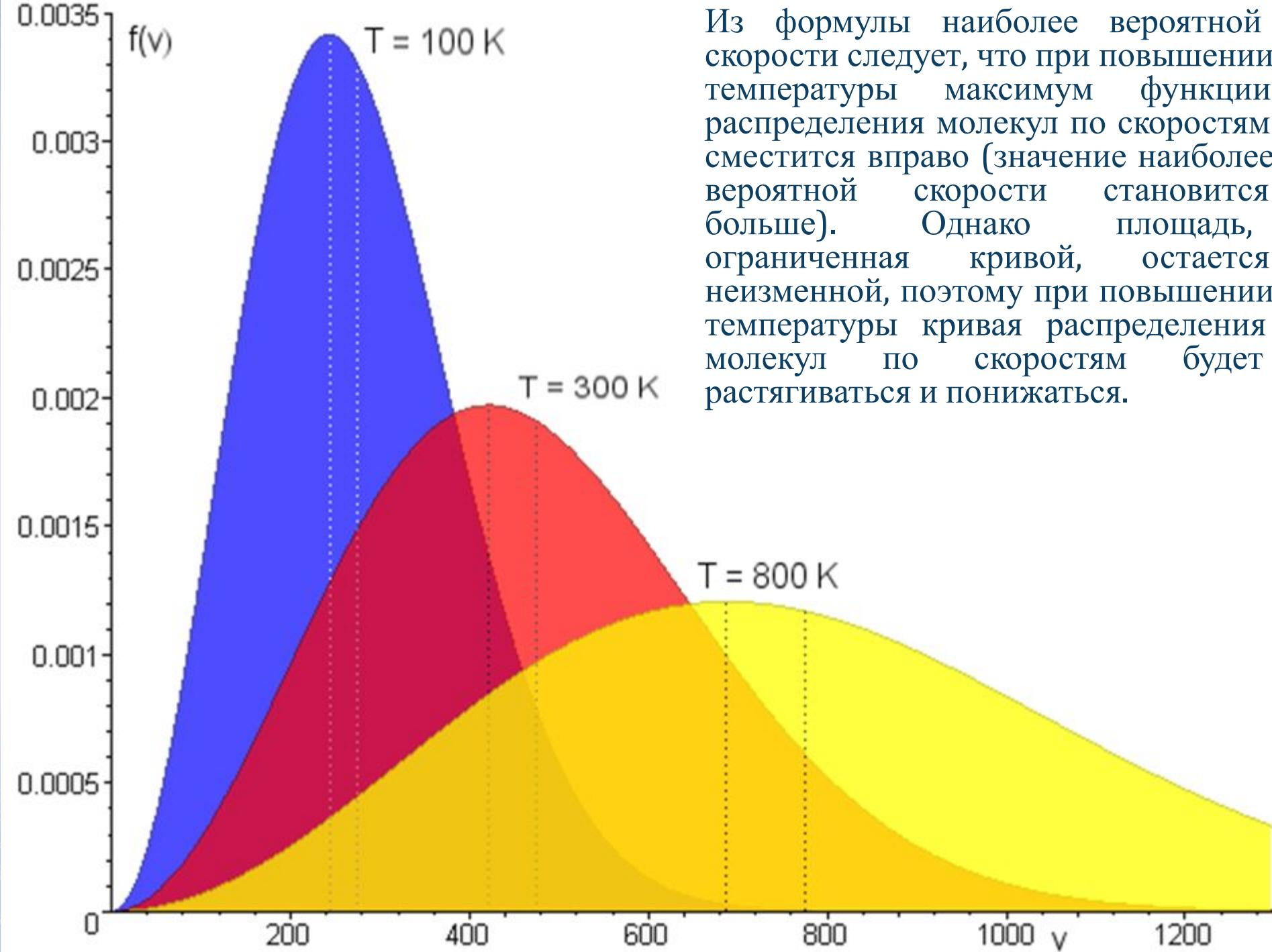
Из формулы наиболее вероятной скорости следует, что при повышении температуры максимум функции распределения молекул по скоростям смещается вправо (значение наиболее вероятной скорости становится больше). Однако площадь, ограниченная кривой, остается неизменной, поэтому при повышении температуры кривая распределения молекул по скоростям будет растягиваться и понижаться.
