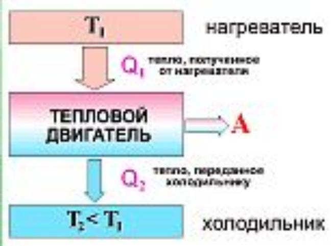
От термостата с более высокой температурой  $T_1'$ , называемого **нагревателем**, за цикл отбирается количество теплоты  $Q_1'$ , а термостату с более низкой температурой  $T_2'$ , называемому **холодильником**, за цикл передается количество теплоты  $Q_2'$ , при этом совершается работа  $A = Q_1 - Q_2$ .
