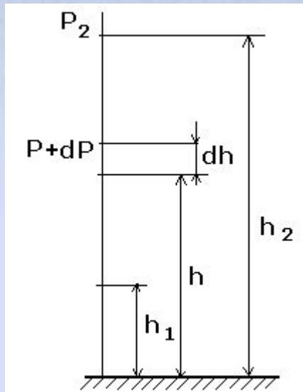
При выводе основного уравнения молекулярно-кинетической теории газов и максвелловского распределения молекул по скоростям предполагалось, что на молекулы газа внешние силы не действуют, поэтому молекулы равномерно распределены по объему. Однако молекулы любого газа находятся в потенциальном поле тяготения Земли. Тяготение, с одной стороны, и тепловое движение молекул — с другой, приводят к некоторому стационарному состоянию газа, при котором давление газа с высотой убывает.
