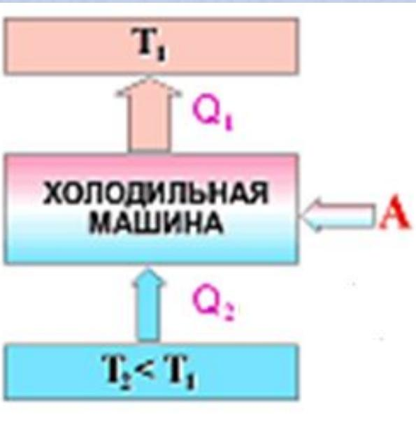
Процесс, обратный происходящему в тепловом двигателе, используется в *холодильной машине*. Системой за цикл от термостата с более низкой температурой  $T_2$  отбирается количество теплоты  $Q_2$  и отдается термостату с более высокой температурой  $T_1$  количество теплоты  $Q_1$ .
