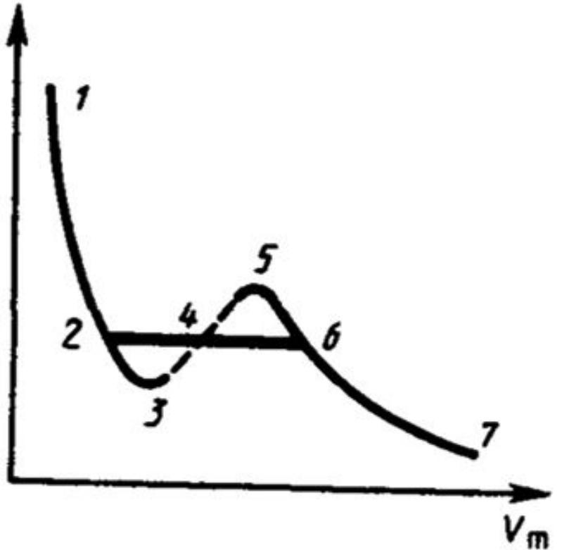
Часть 6–7 отвечает газообразному состоянию, а часть 2–1 — жидкому. В состояниях, соответствующих горизонтальному участку изотермы 6–2, наблюдается равновесие жидкой и газообразной фаз вещества. Вещество в газообразном состоянии при температуре ниже критической называется **паром**, а **пар**, находящийся в равновесии со своей жидкостью, называется **насыщенным**.
