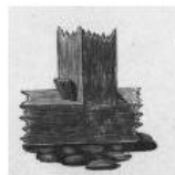
б) замок в полулапу
